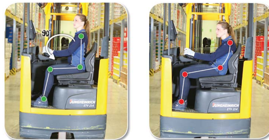
Slika 3. Ispravan i pogrešan način držanja tijela prilikom vožnje sjedećeg viličara
